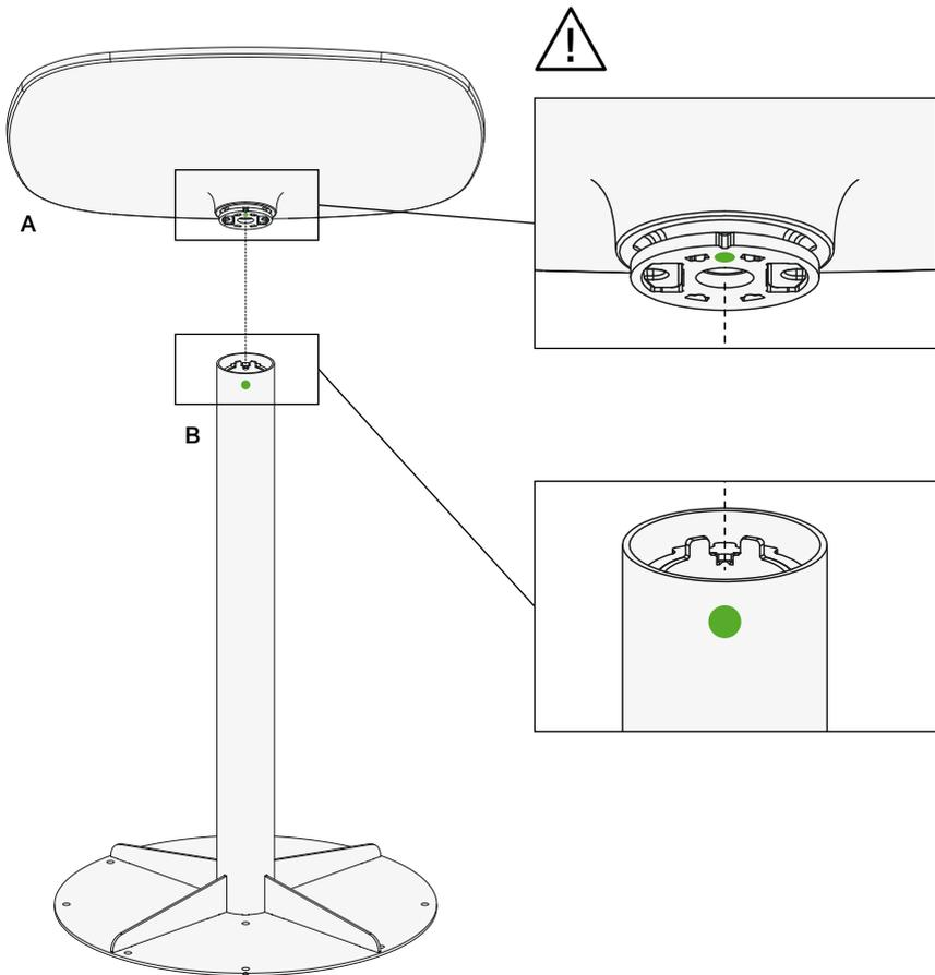
IT Avvitare completamente la vite C a mano, successivamente stringere utilizzando l'apposita chiave. Ad operazione conclusa, capovolgere la base.
