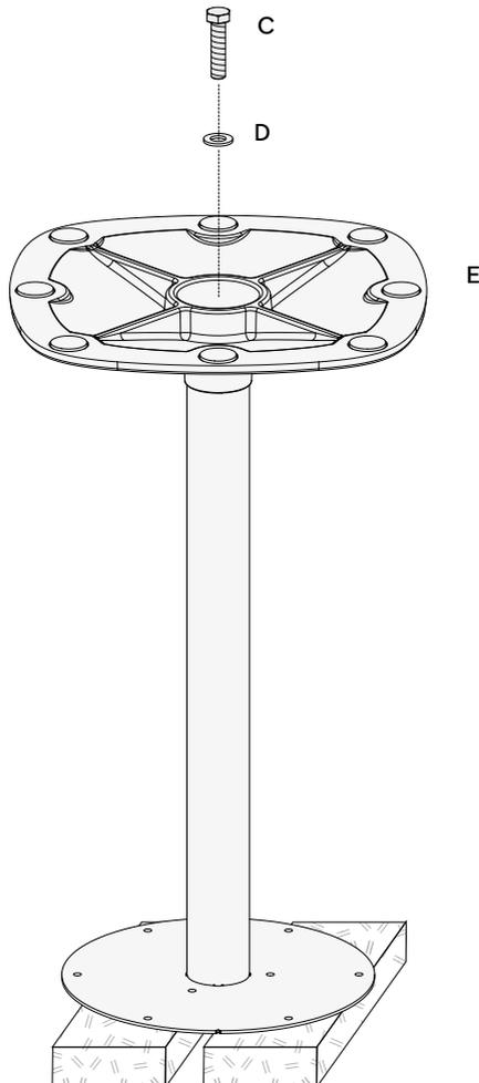
IT Posizionare il Top e avvitare le viti centrali, successivamente quelle lungo il perimetro.
