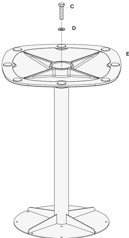
**IT** Posizionare il Top e avvitare le viti centrali, successivamente quelle lungo il perimetro.
