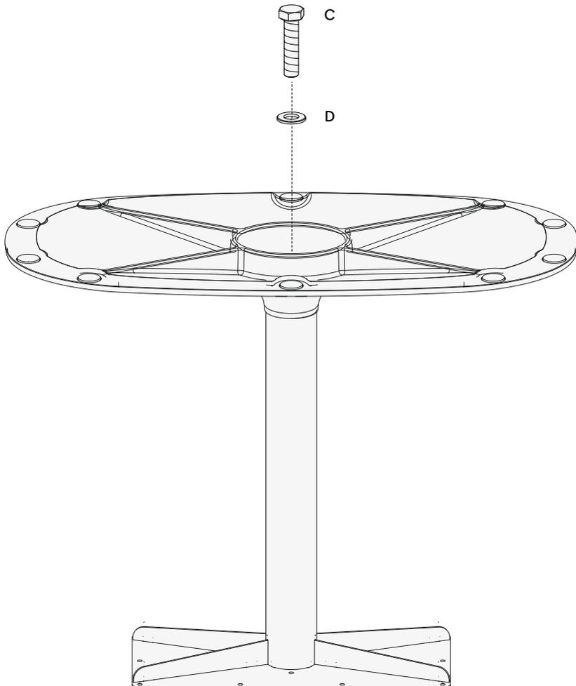
**IT** Posizionare il Top e avvitare le viti centrali, successivamente quelle lungo il perimetro.
