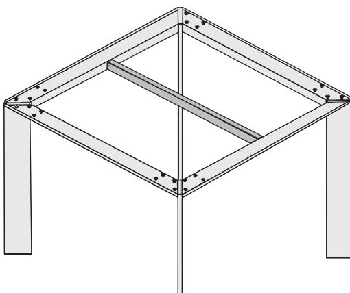
**6****Posizionare il piano facendo attenzione che sia allineato in modo uniforme alla struttura.**
